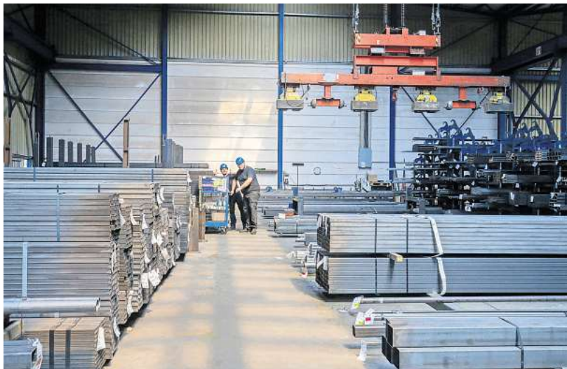
Ein Blick in die Stahlhalle: Mit dem Magnetkran, der an der Decke befestigt ist, werden die schweren Materialien transportiert.
